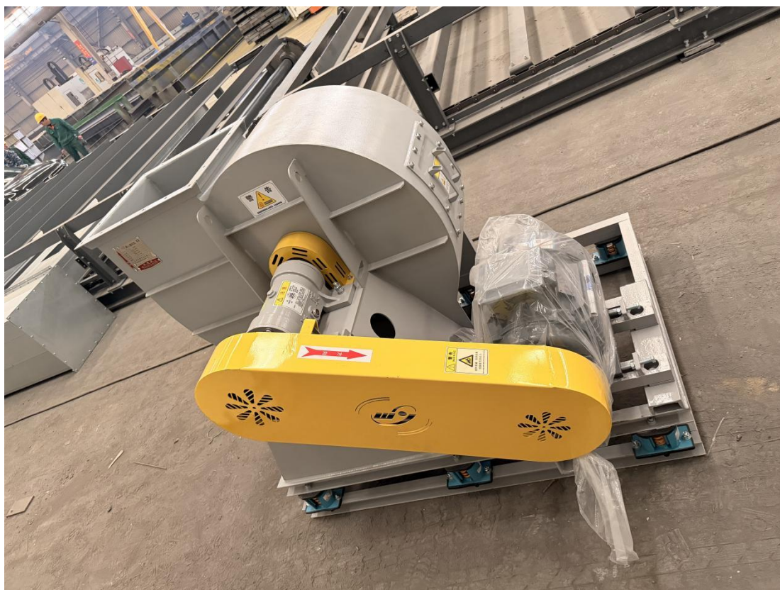
Dust Removal Fan
